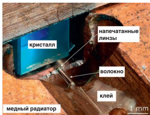
Микромасштабные линзы, напечатанные непосредственно на оптических волокнах. Фото: Мориц Флоесс/Саймон Ангстенбергер
