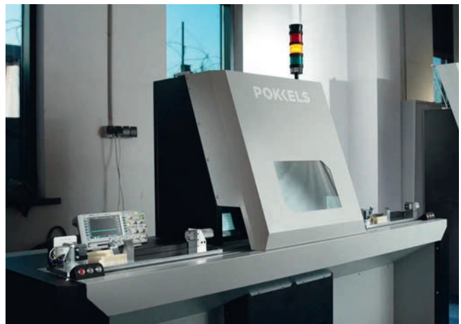
Рис. 10. Автоматизированная система Pokkels для сварки элементов электроусилителя руля. Фото: ООО «Поккельс»
