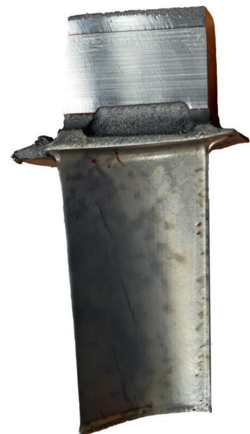
Рис. 13. Перо лопатки и переходный радиус, изготовленные по технологии импульсной ЭХО
