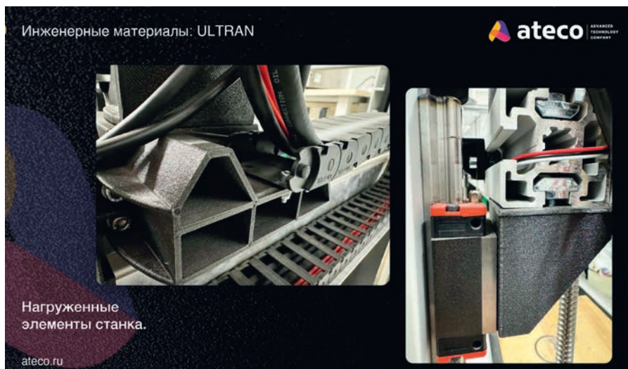
Рис. 3. Элементы станка, выполненные из материала и на оборудовании ООО «Атеко». Фото: ООО «Атеко»
