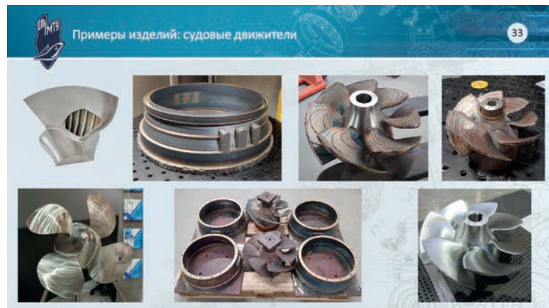
Рис. 7. Примеры напечатанных изделий для судостроения. Фото: ИЛИСТ СПбГМТУ
