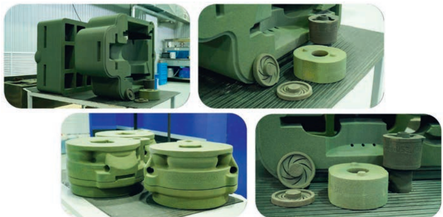
Рис. 8. Печать песчаных форм для изготовления элементов корпуса и рабочих колес. Фото: Top 3D Group
