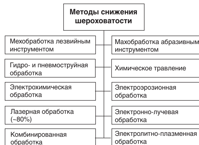
Рис. 1. Основные методы и технологии дополнительной обработки заготовок АП
