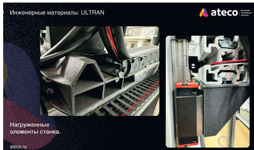
Рис. 4. Элементы станка, выполненные из материала и на оборудовании ООО «Атеко». Фото: ООО «Атеко»
