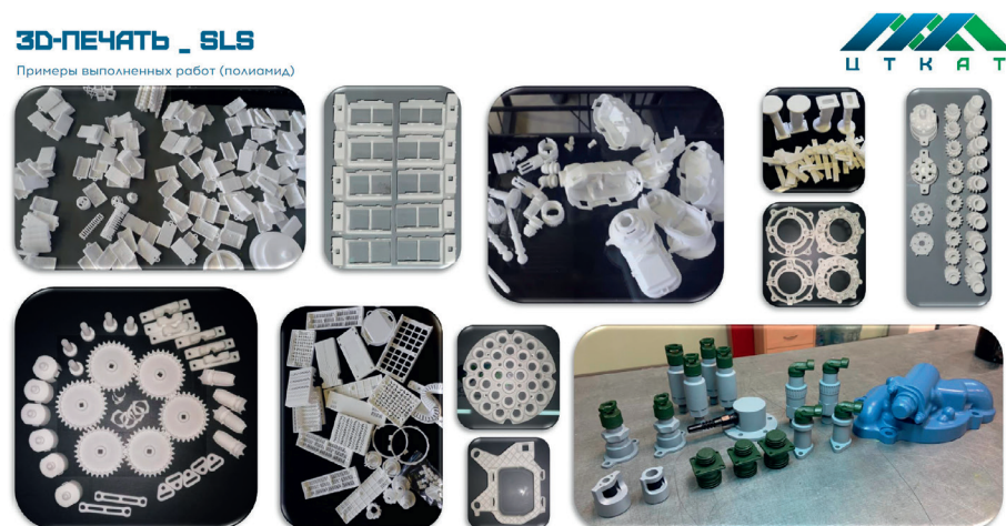
Рис. 6. Детали из полиамида, напечатанные в ЦТКАТ
