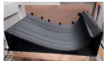
▼ РИС. 6. Шестерня (а) и крупногабаритная оснастка для выкладки (б), напечатанные из микрогранул ПАБ марки Ultran, наполненных углеродными волокнами (источник: Ateco)
