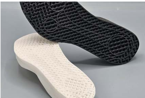
РИС. 2. ▶ Примеры пластиковых изделий сложной формы, напечатанных по АТ синтеза на подложке на принтере производства «ОНСИИТ»
