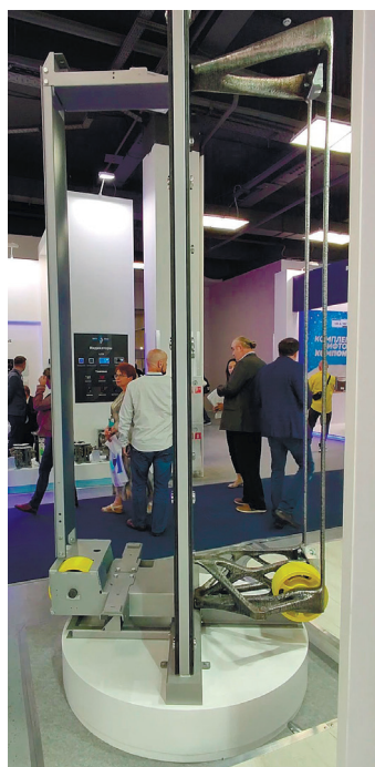
Рис. 9. Слева — половина несущего корпуса лифта, изготовленного и собранного по обычной технологии, справа — половина корпуса лифта, напечатанная по WAAM технологии и сваренная в единое целое изделие (ОАО «Могилевлифтмаш»)
