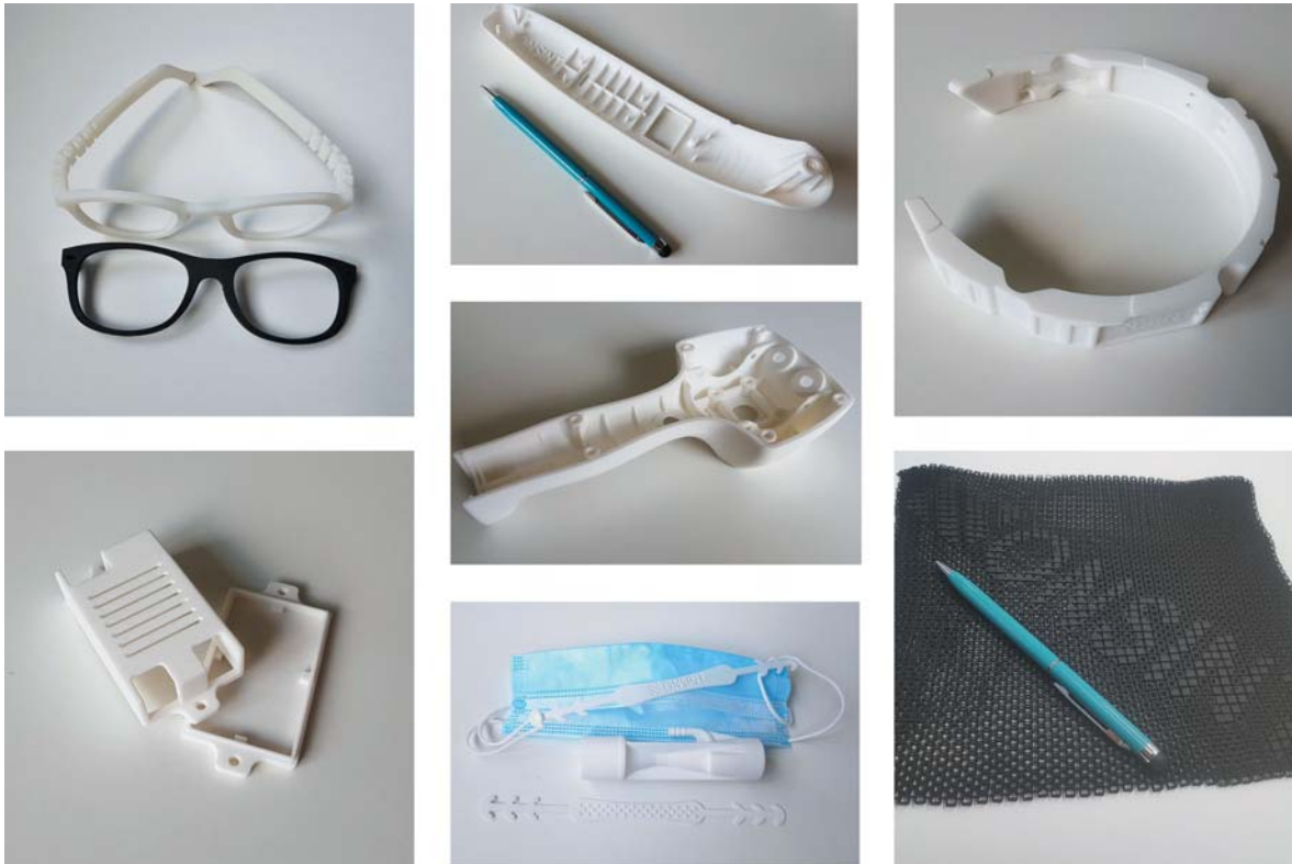
Рис. 6. Примеры изделий, напечатанных на принтерах «ОНСИИТ» из ПА типа PA11 black, PA11 white, и PA12 white/natural
