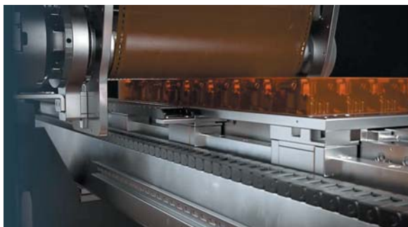
РИС. 7. ► Конвейерный тип стола с декартовой системой координат, технология STEP, компания Evolve Additive Solutions [6]
