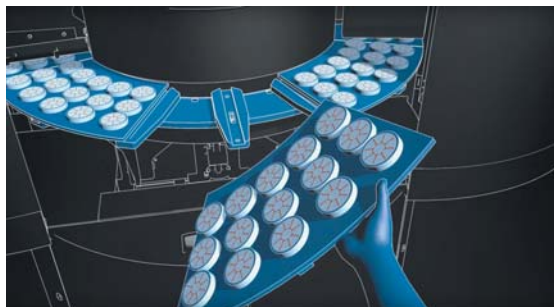
РИС. 11. ▶ Визуализация замены секции роторного стола технологии HSR, которая может осуществляться как человеком, так и РТК, компания dp Polar [14]
