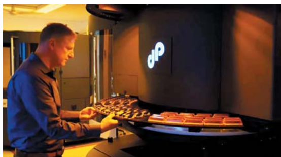
РИС. 10. ▶ Процедура замены секции 3D-принтера AMpolar с полярной системой координат, компания dp Polar [14]
