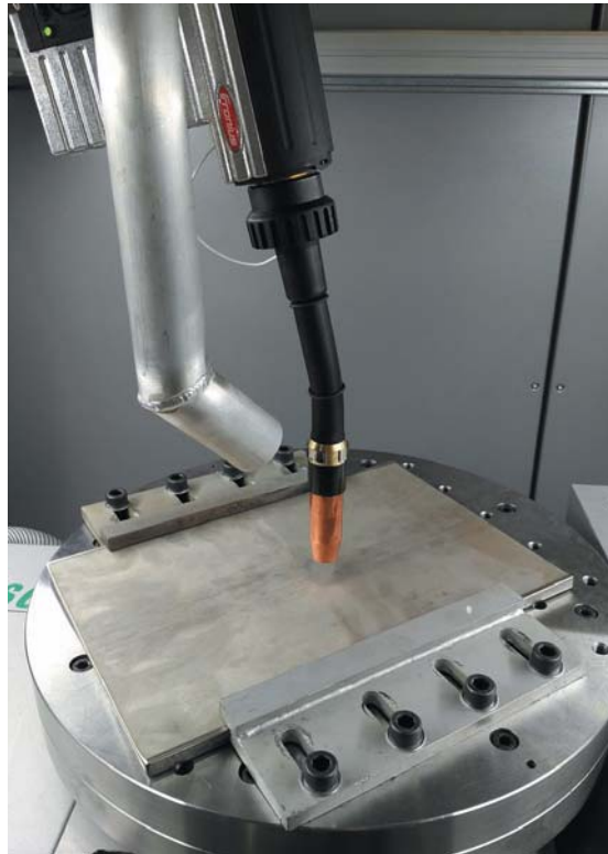
РИС. 6. ► Круглый поворотный стол на 3D-принтере Gefertec arc405, технология 3DMP/WAAM, компания Gefertec [4]
