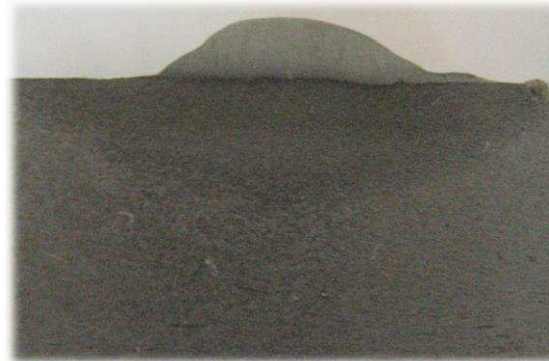
Макрошлиф наплавленного валика на токе обратной полярности
