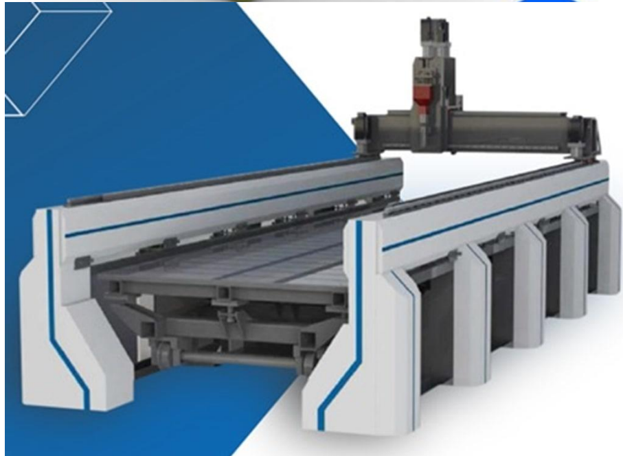
Пяти осевой аддитивный обрабатывающий центр (диаметр рабочей области до 1 метра)
