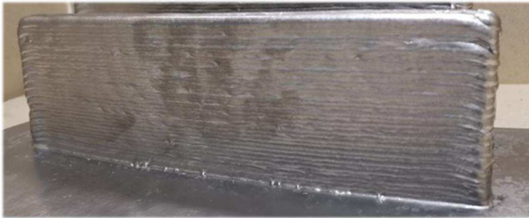
Фотографии стенки, наплавленной для изготовления образцов дополнительных испытаний
