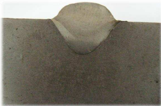
Макрошлиф наплавленного валика на токе прямой полярности
