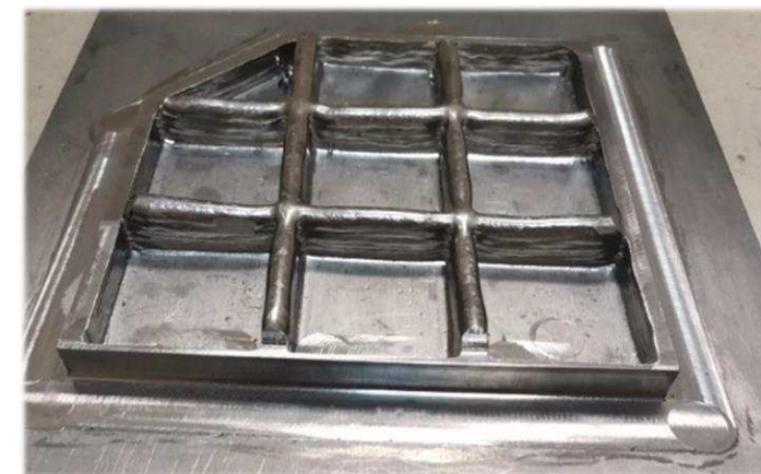
Фотография частично обработанного макета изделия «сотовая панель» (Материал – ВТ6ч)
