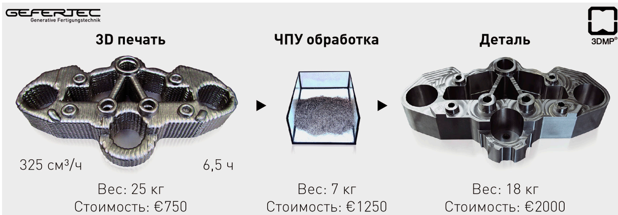
Рис. 4. Изготовление шейки вала по аддитивной технологии 3DMP®
