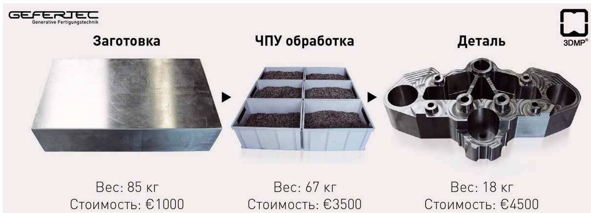
Рис. 3. Изготовление шейки вала по традиционной технологии
