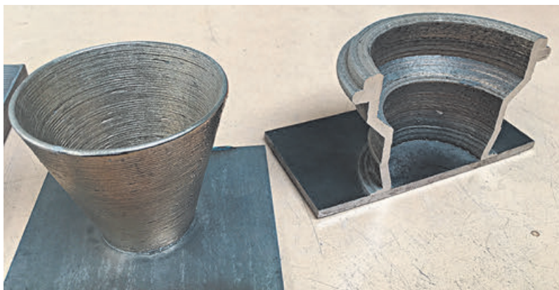
Опытные работы по технологии газопорошковой наплавки LENS на оборудовании OPTOMECS LENS 850 (Национальная высшая школа искусств и ремесел)
