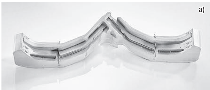
Элемент пресс-формы с напечатанными ламелями (а) для производства шин Michelin CrossClimate (б)
