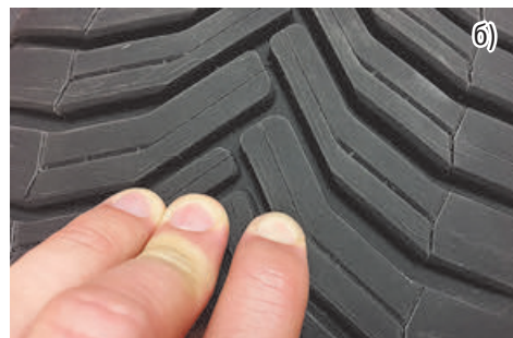
Элемент пресс-формы с напечатанными ламелями (а) для производства шин Michelin CrossClimate (б)
