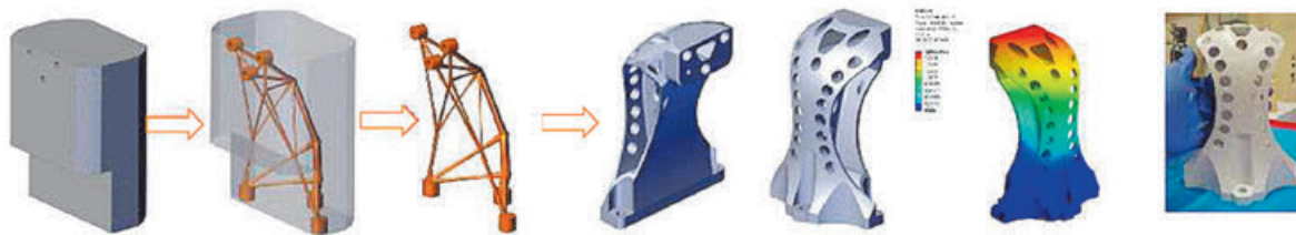
Техпроцесс на примере создания из керамики детали «Стабилизатор»
