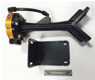
Рис. 13. Готовое вакуумное приспособление для роботизированного манипулятора и перемещаемая им деталь
