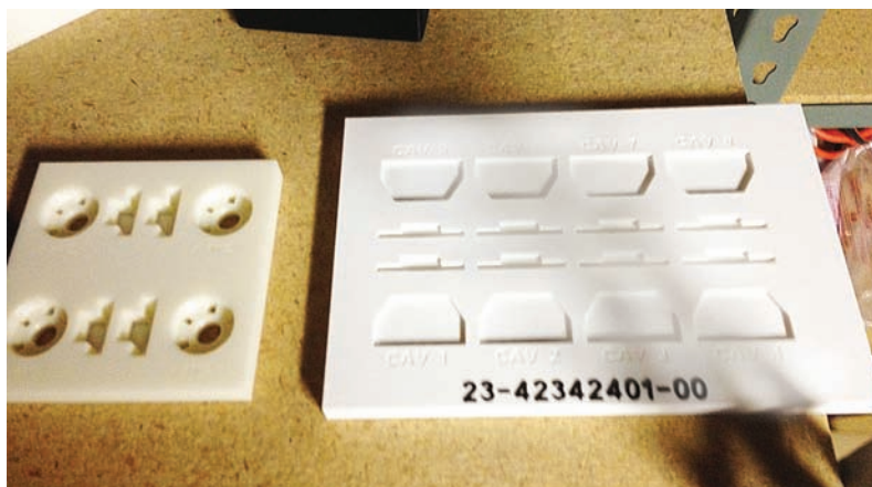
Рис. 17. Набор специальных приспособлений, напечатанный на установке FDM, предназначен для сборки электрических разъемов различной конфигурации
