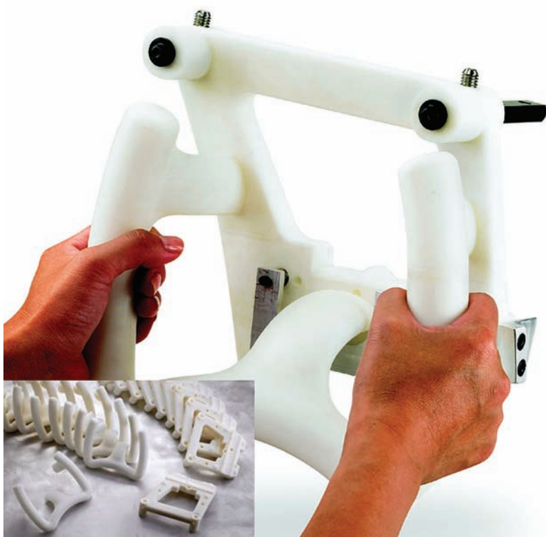
Рис. 7. Напечатанный из ABS-M30 по технологии FDM ложемент используется как базировочная оправка для крепления эмблемы на крышку багажника автомобиля BMW
