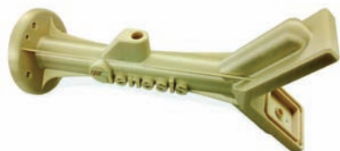
Рис. 12. Так выглядит захват для манипулятора, напечатанный по технологии FDM из материала ULTEM 9085. Захват выполнен с внутренними вакуумными каналами
