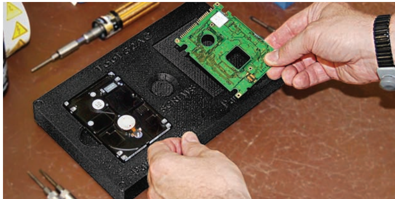
Рис. 3. Для сборки жесткого диска используется ложемент, напечатанный по технологии FDM из электростатически нейтрального материала ABS-ESD7
