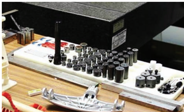
Рис. 9. Инструментальный «органайзер», изготовленный с использованием технологии FDM
