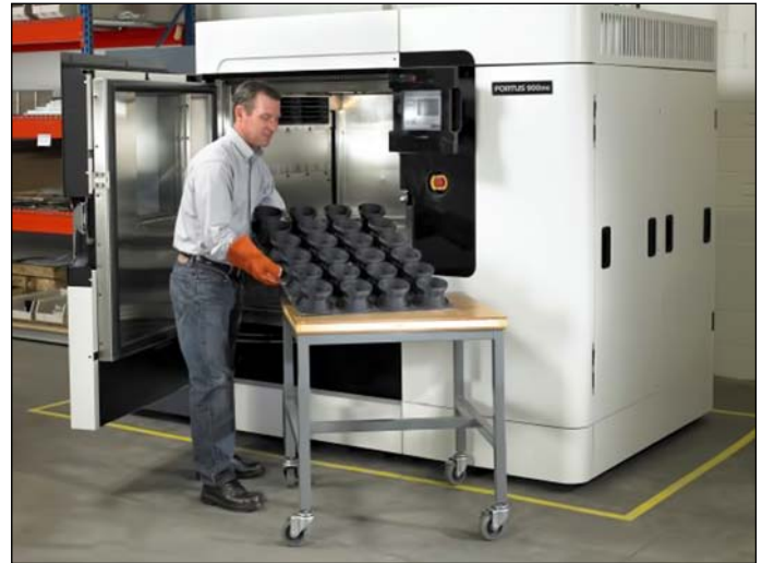
На установках промышленного класса Fortus можно изготавливать малые партии деталей
