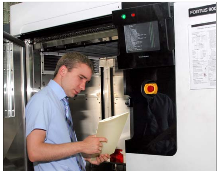
На установке Fortus 900mc в компании «Солвер» изготавливаются модели-прототипы и конечные детали
