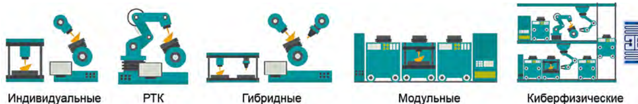
Рис. 13. Основные укрупненные компоновочные решения аддитивного оборудования (изображение предоставлено ООО «Современное оборудование», Россия)
