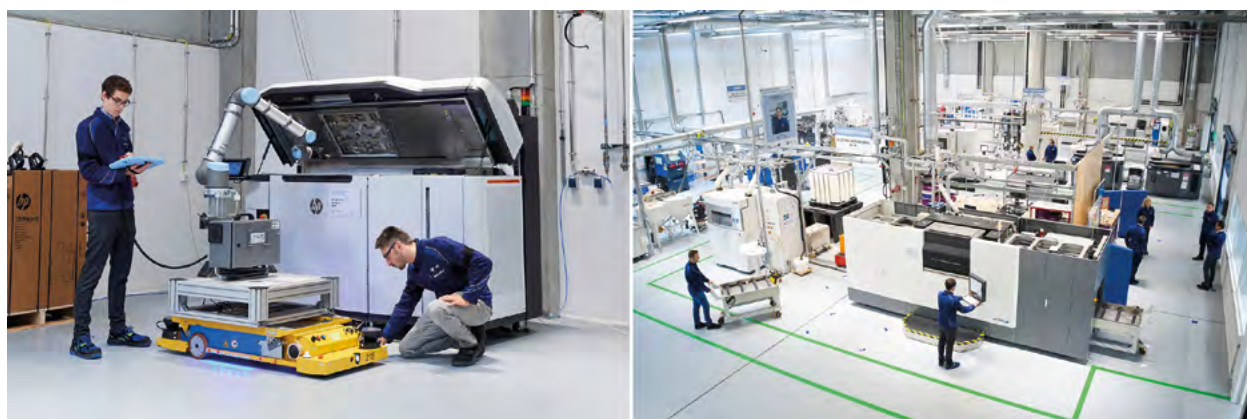
Рис. 7. Первые попытки автоматизации в кампусе аддитивного производства BMW Group. Слева показано использование коллаборативного манипулятора Universal Robots, автоматической тележки, принтера HP Multi Jet Fusion (изображение предоставлено BMW Group, Германия)
