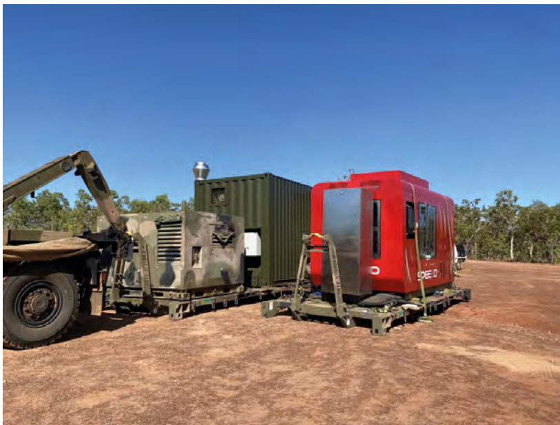
Рис. 3. Высокоскоростной металлический Cold Spray принтер WarpSPEE3D – быстрое полевое развертывание и неприхотливость (изображение предоставлено SPEE3D, Австралия)
