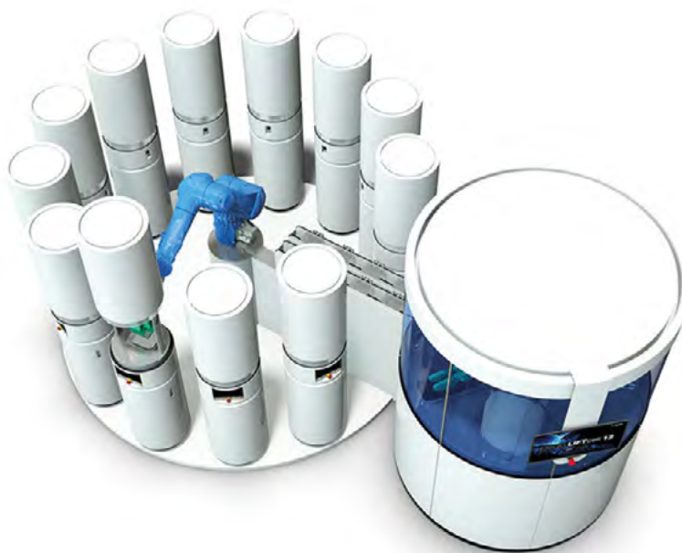
Рис. 10. Модульная линия для печати, постобработки, и хранения деталей LIFTcell2 (изображение предоставлено Coobx AG, Лихтенштейн)
