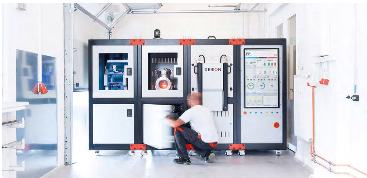
Рис. 6. Модульная Metal FDM система Fusion Factory, разработанная при участии сотрудников института Фраунгофера (изображение предоставлено Xerion Berlin Laboratories GmbH, Германия)
