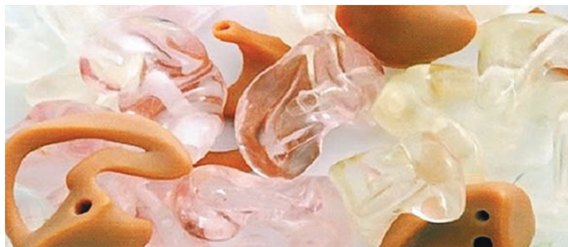
Рис. 1. Технология PolyJet позволяет быстро и качественно изготавливать индивидуальные заушные слуховые аппараты
