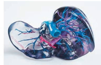
Рис. 3. Эти высокоточные модели для планирования операций также созданы по технологии PolyJet
