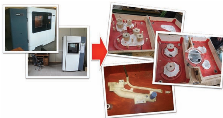
Рис. 10. Изготовление модельных плит и закрепление моделей FDM
