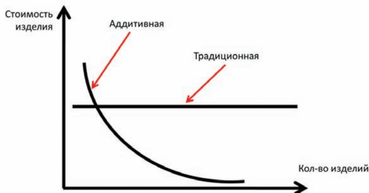
Рис. 7. Сравнение эффективности применения аддитивной и субтрактивной технологии
