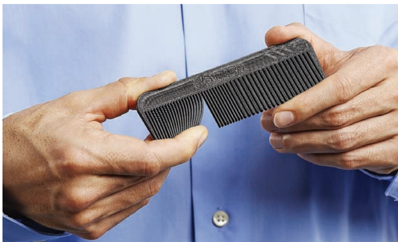
Рис. 5. Этот гребень из материала Nylon 12 изготовлен по технологии FDM
