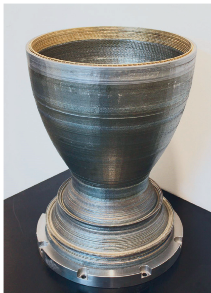
Рис. 3. Полиметаллическое ракетное сопло, напечатанное по технологии DMT/DED-P (фото: Insstek, Корея)
