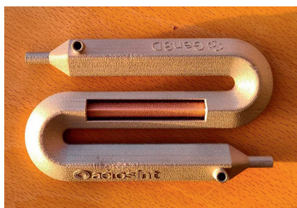
Рис. 15. Биметаллическая 3d-печать теплообменника из материалов CuCrZr и AISI 316L (фото: Aerosint SA (ныне Desktop Metal, США))
