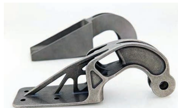
Рис. 13. Кронштейн, изготовленный по технологии SLM (на переднем плане), функционально идентичен образцу, полученному по классической технологии. Разница в весе – около 50%
