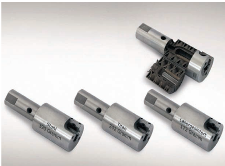
Рис. 7. Корпуса разверток, изготовленные по аддитивной технологии
