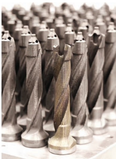
Рис. 6. Корпуса сверл, изготовленные по аддитивной технологии
