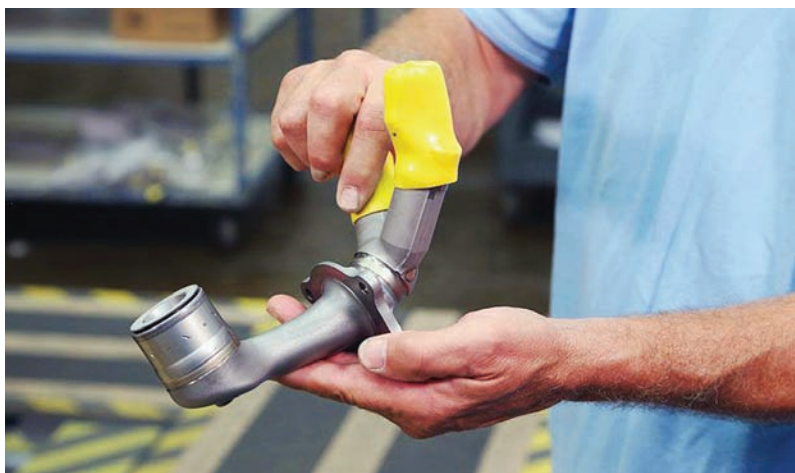
Рис. 8. Топливная форсунка авиадвигателя, изготовленная по аддитивной технологии
