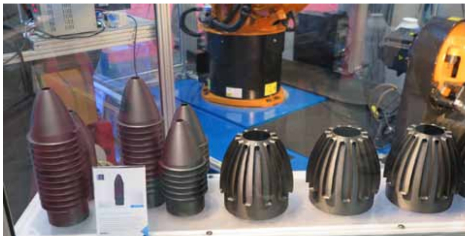
Рис. 8. Применение Robotic Composite 3D для выпуска легких деталей в авиационной и автомобильной промышленности
